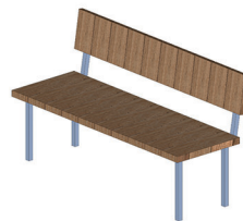
Mebles dolnego tarasu: siedziska i tablice informacyjne z profili stalowych, krawędziaków i listew drewnianych
